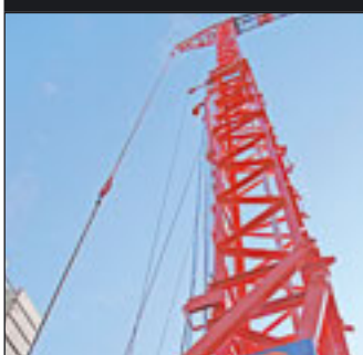
Arcomets A45D hat eine Hakenhöhe von 30,5 Metern
